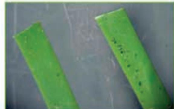
Deux fibres avant (gauche) et après (droite) l'essai d'usure. Quelle est la différence? Pratiquement aucune.
